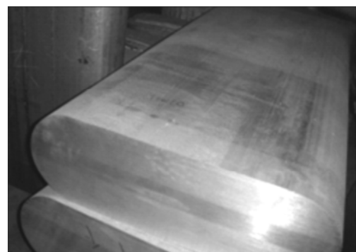
图 5 按最优工艺参数铸造的 7050 铝合金扁锭照片 Fig.5 Photo of 7050 Al alloy ingot with optimized parameters
