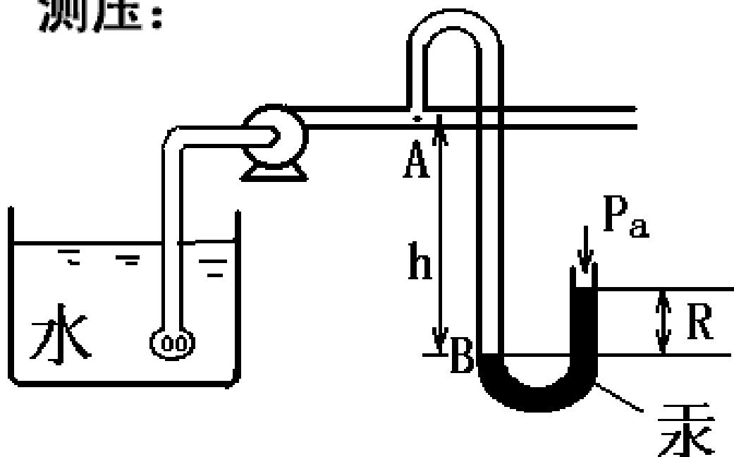
已知:  $R=180\text{mm}$ ,  $h=500\text{mm}$
