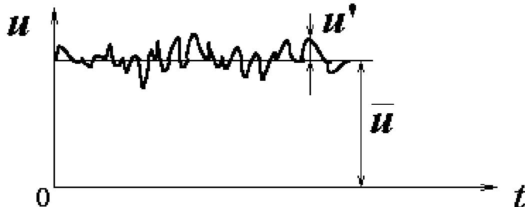
$$\text{速度} = \text{时均速度} + \text{脉动速度} \quad u = \bar{u} + u'$$
