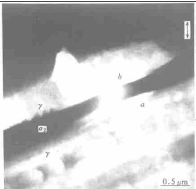
图6 90°取向 PST 晶体 TEM 原位拉伸照片
