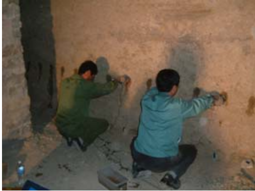
图 6 洞窟内高密度电阻率探测现场
