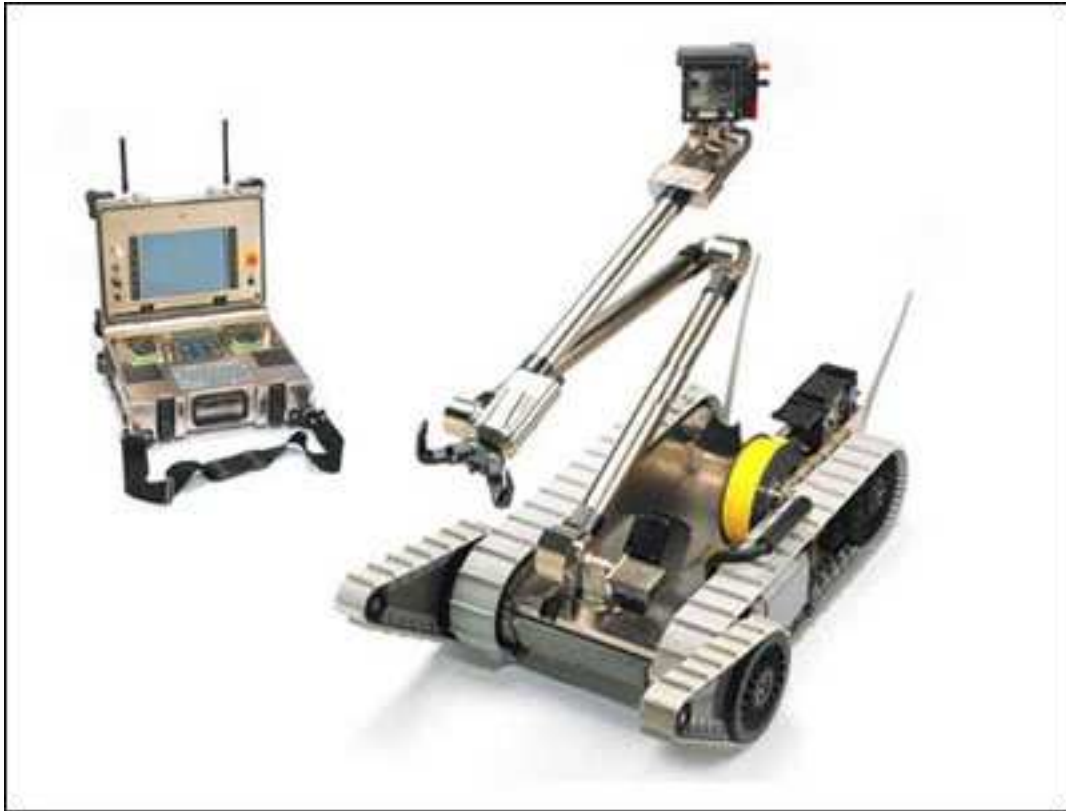
PackBot 结构小巧，被称为“背包机器人”（资料图片）
