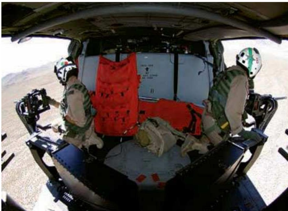
MH-60S Block III 型**武装直升机**配备了两个门，有利于“海豹”突击队员在执行营救任务的同时快上快下，更好地进行自我防护。
