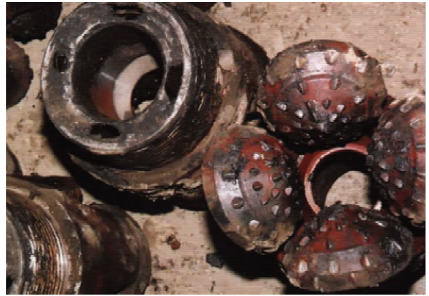
图 2 科拉科学超深井用的牙轮取芯钻头
