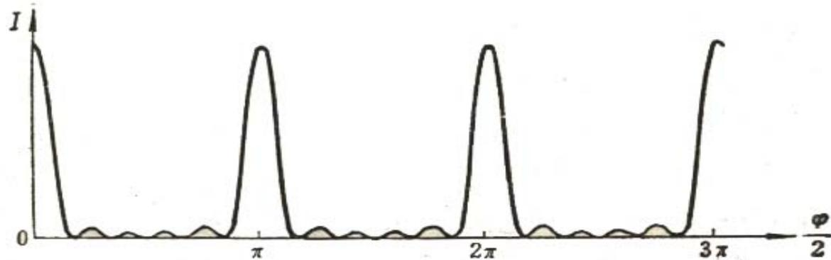
当 $G$ 、 $G'$ 面的反射率很大时（实际上可达90%，甚至98%以上），由 $G'$ 透射出来的各光束的振幅基本相等，这接近于等振幅的多光束干涉。计算这些光束的叠加结果，
