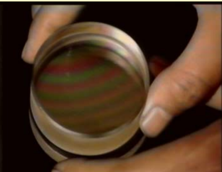
平晶间空气隙干涉条纹
