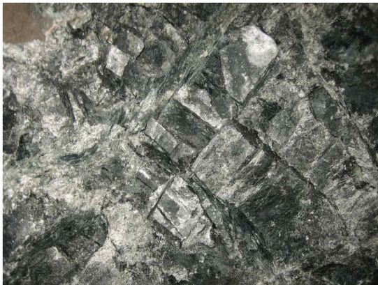
图 2 旧堡隧道 Dk30+520-910 段施工揭露的麻粒岩(左)和黑云斜长片麻岩(右)
