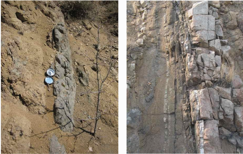
图7 隧道正洞地表出露的辉绿岩脉(左)和花岗伟晶岩脉(右)
