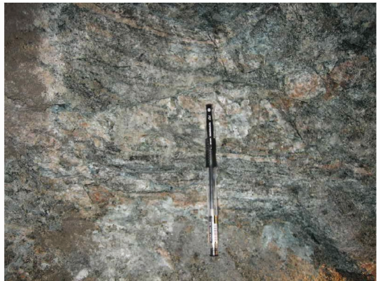
图 2 旧堡隧道 Dk30+520-910 段施工揭露的麻粒岩(左)和黑云斜长片麻岩(右)
