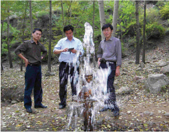
图4 旧堡隧道 ZD241 孔承压水及 2#斜井施工中的突发涌水
