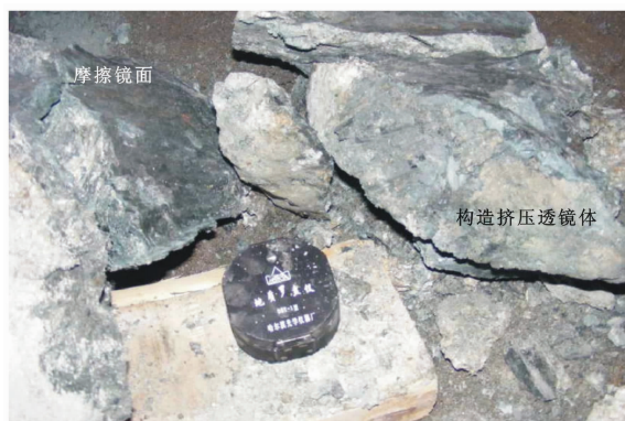
图6 麻粒岩与黑云斜长片麻岩之间的构造挤压破碎带
