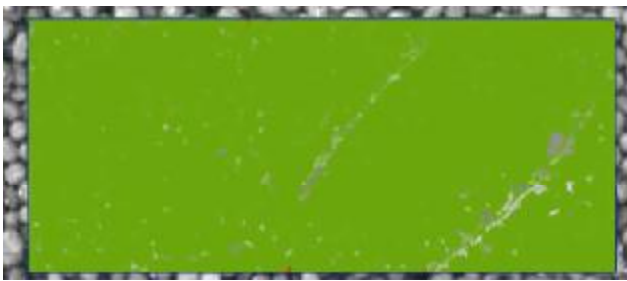
图 4 利用斑点分析提取图像中的黑斑点
