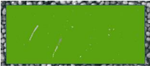
图 5 用斑点分析提取图像中的白斑点
