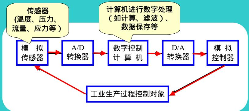
ADC和DAC已成为计算机系统中不可缺少的接口电路。
