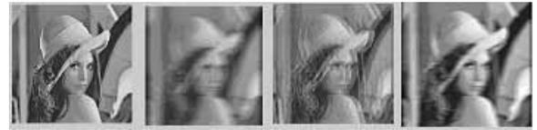
(a)原始图像 (b)模糊图像 (c)维纳滤波图像 (d)本文方法图像
