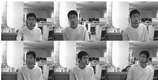
图 2 含有人脸平移和水平旋转运动的人脸视频跟踪结果
