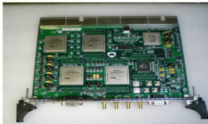
图12 VLBI 数字基带转换器信号处理板
