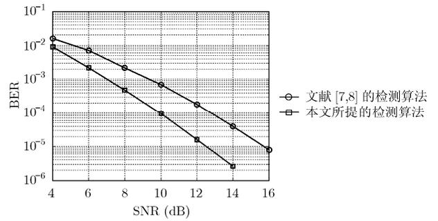
图 5 信道编码系统，不同检测算法性能比较( $f_d T_s = 9.58e - 2$ )
