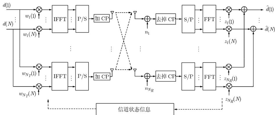
图 1 闭环 MIMO-OFDM 系统框图
