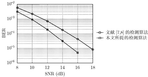
图 3 没有信道编码系统，不同检测算法 BER 性能比较( $f_d T_s = 9.58e - 2$ )
