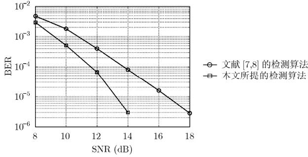
图 2 没有信道编码系统，不同检测算法 BER 性能比较( $f_d T_s = 4.74e - 2$ )
