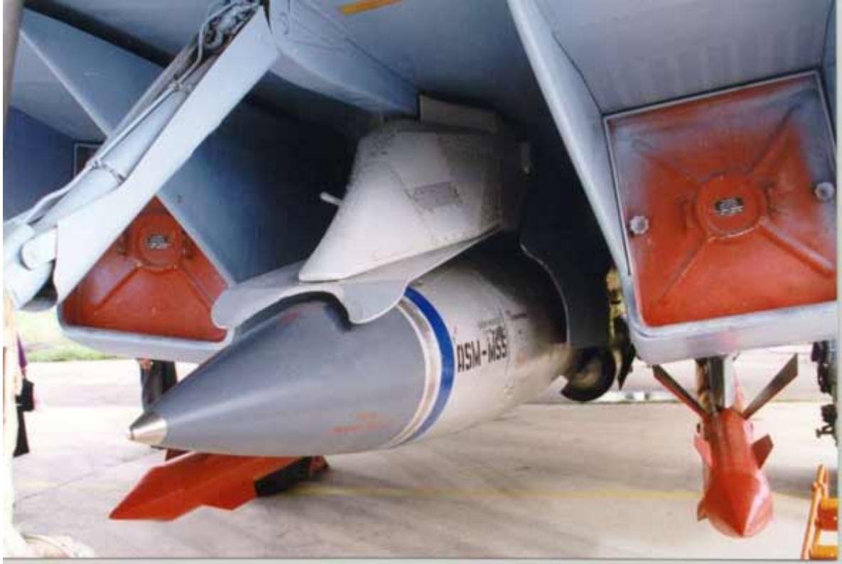
两个进气道之间挂载的 ASM-MS 反舰导弹[资料图片]
