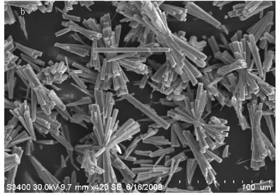
图2 棒状纳米氧化锌的 SEM(a.0.01 mol /L CTAB;b.加入 0.1 mol /L CTAB)
