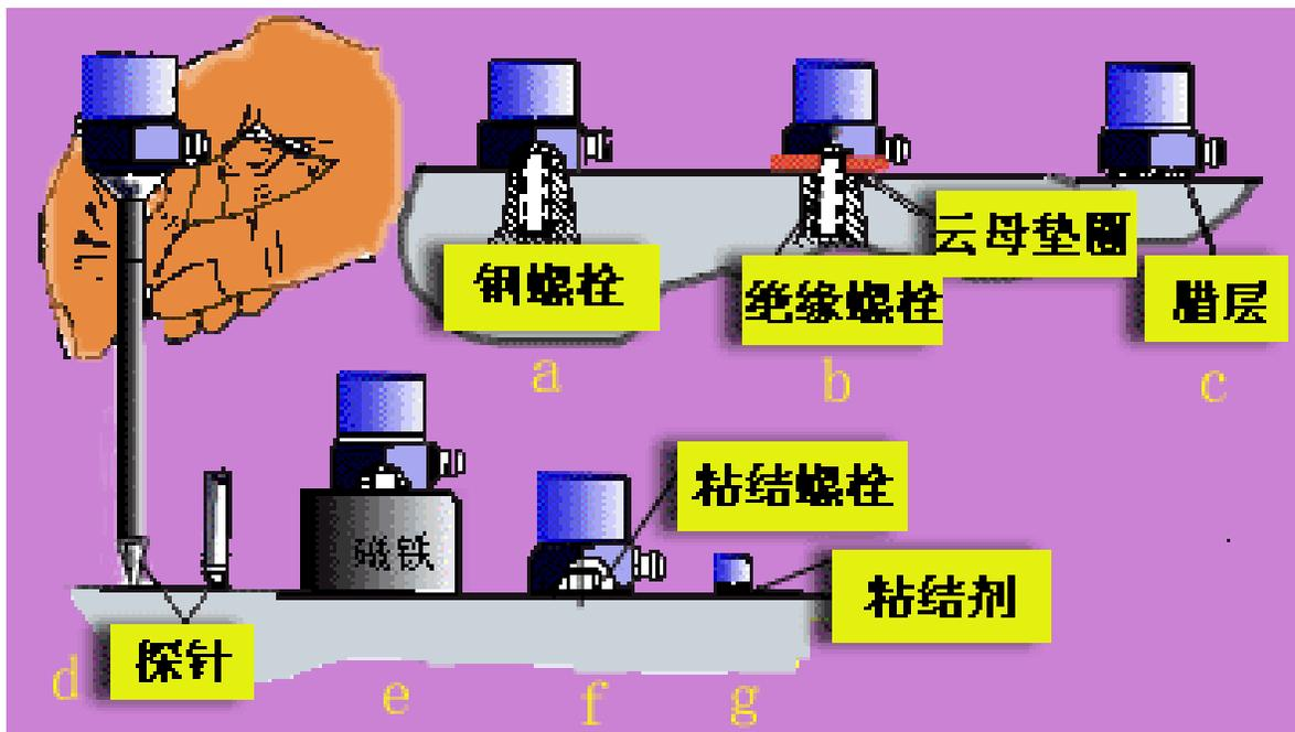
某加速度计采用各种固定方法的谐振频率分别约为：钢螺栓固定法31kHz，云母垫片28kHz，涂簿蜡层29kHz，手持法2kHz，永久磁铁固定法7kHz。
