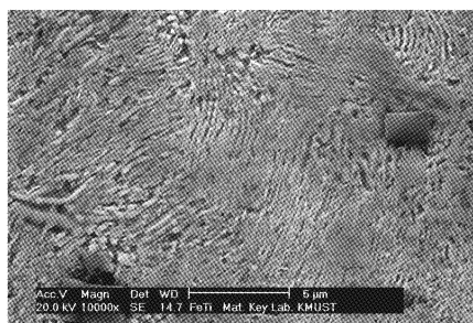
图 3 复合材料 L1 铸态组织(腐蚀态) Fig.3 Microstructure of L1 composite as cast (eroded)
