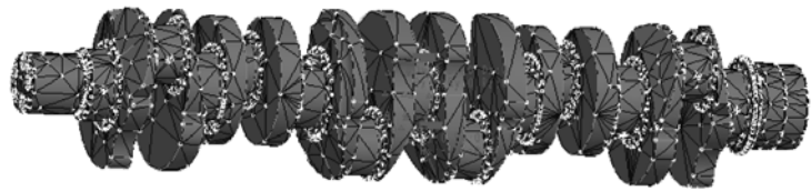
图6 曲轴的网格划分 Fig.6 Mesh grid of crankshaft
