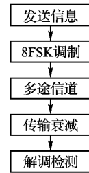
图 4 单跳通信流程
