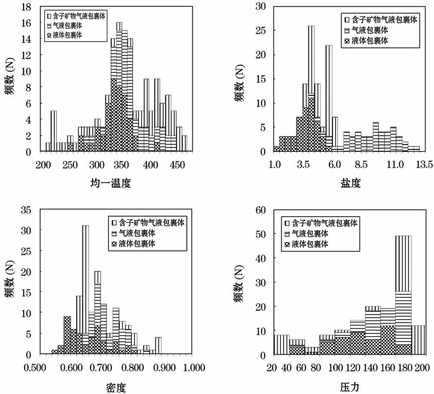
图2 双朋西金铜矿床流体包裹体温度、盐度、密度、压力分布直方图
