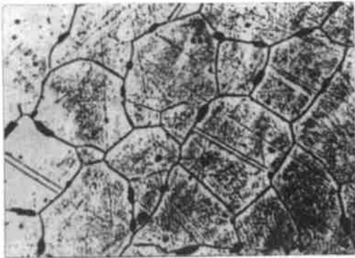
图 1 进气管实物金相组织草酸电解浸蚀 500 ×
