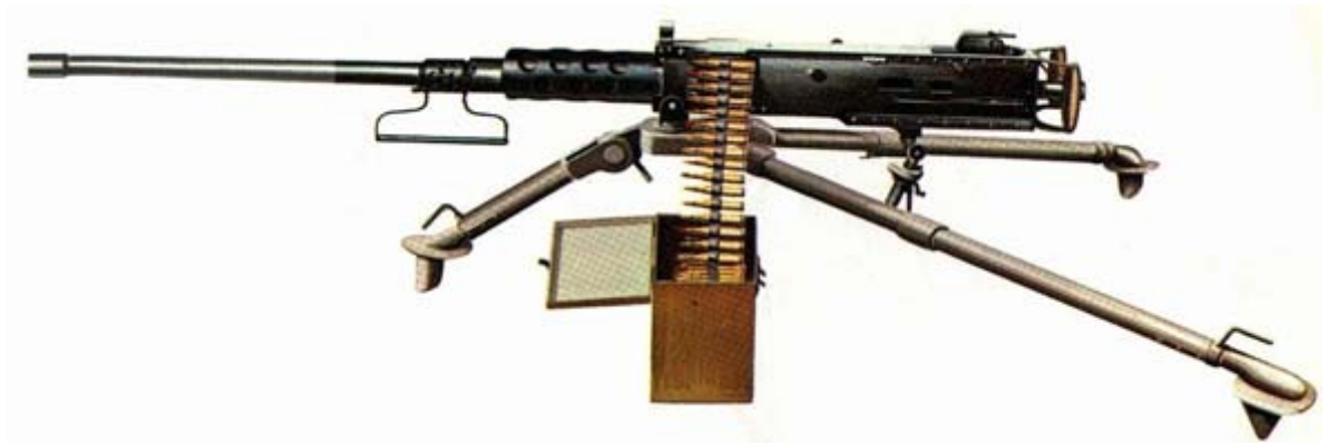
M2HB 型 12.7 毫米重机枪 [千龙军事]
