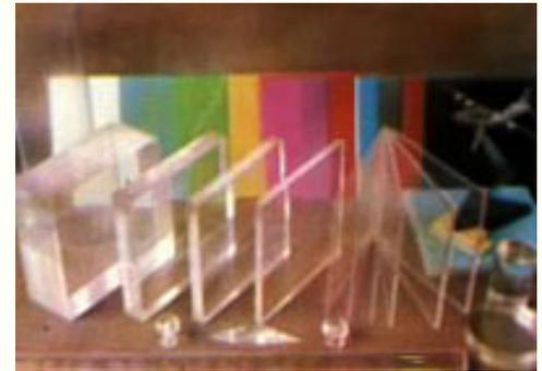
PMMA具有良好的透光度和光泽度，并且具有较高的抗冲击强度，但其熔融粘度大、流动性差，加工成型较困难。
