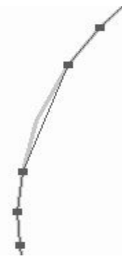
图 1 两节点间的直线距离取代曲线距离时会产生一定的误差
