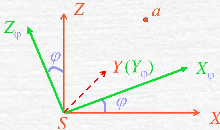
$$\begin{bmatrix} X \\ Y \\ Z \end{bmatrix} = \begin{bmatrix} \cos \varphi & 0 & -\sin \varphi \\ 0 & 1 & 0 \\ \sin \varphi & 0 & \cos \varphi \end{bmatrix} \begin{bmatrix} X_\varphi \\ Y_\varphi \\ Z_\varphi \end{bmatrix} = \mathbf{R}_\varphi \begin{bmatrix} X_\varphi \\ Y_\varphi \\ Z_\varphi \end{bmatrix}$$
