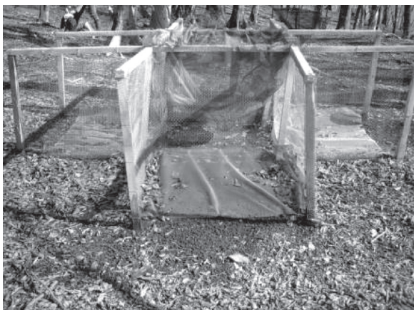
図-6. リター移動量測定柵 斜面下部；高さ0.9 m，開口幅1.0 m，奥行1.0 m。
