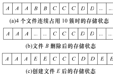
图 1 文件在磁盘上的存储方式
