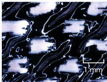
(b) 成形圧力が不十分な場合 (15.7 kPa, 254 )
