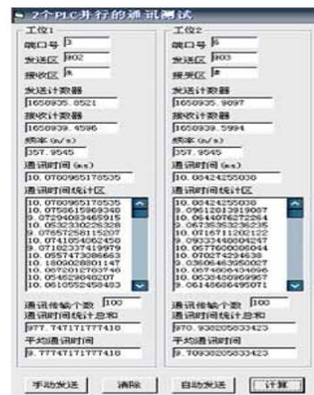
图 4 PC 机与 2 台 PLC 并行通信测试
