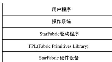
图 5 StarFabric 软件体系结构
