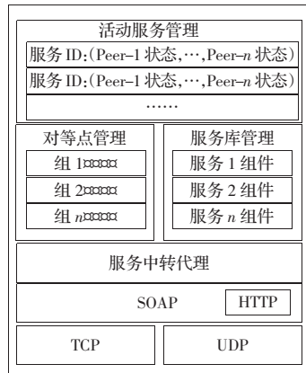
图 2 中控代理服务器内部结构图
