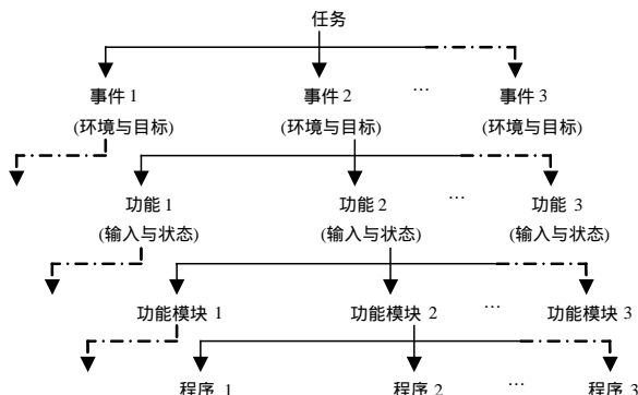
图 1 基于任务剖面的软件系统结构框架
