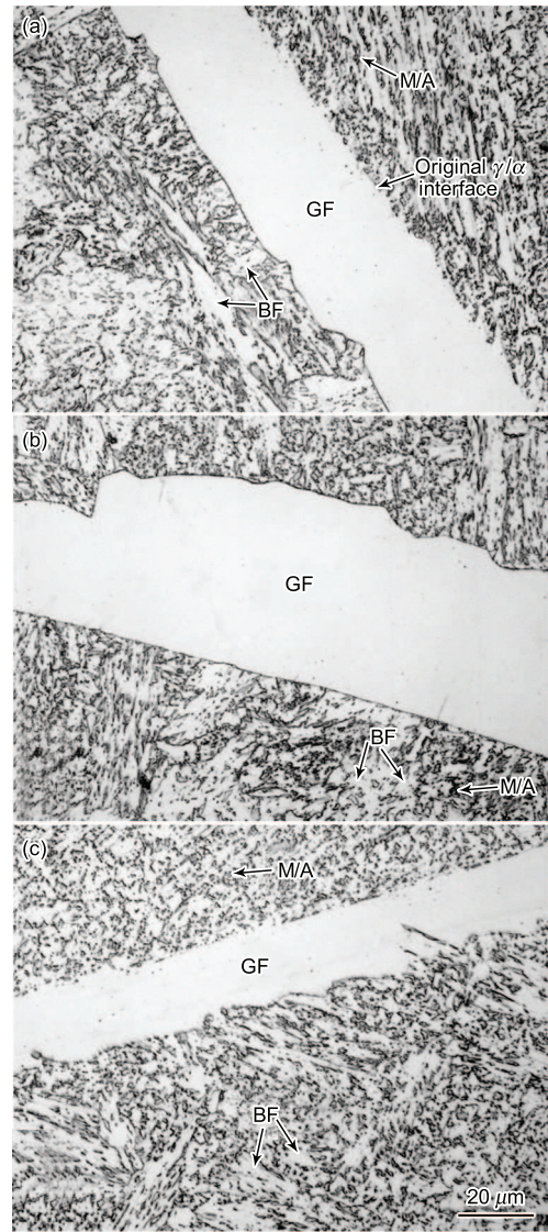
图 3 图 2 所示 Fe-C-Mn-Si 钢的组织中三种不同的晶界铁素体界面的形貌
