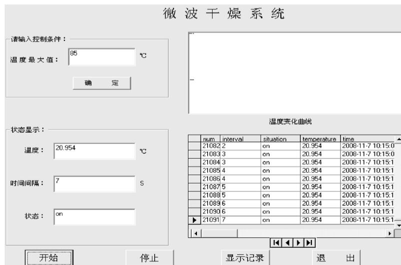
图3 微波干燥监控系统的上位机
