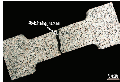
图 7 泡沫铝钎焊试样拉伸断裂形貌
