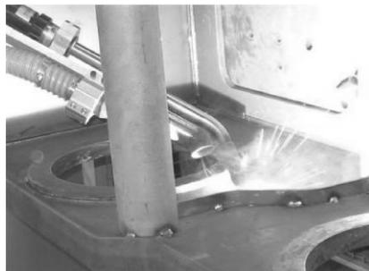
图4 带有吸烟装置的水冷机器人焊枪
