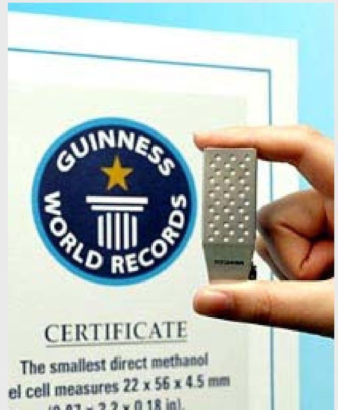
东芝的超小型燃料电池宽22mm，高56mm，厚度最薄部分仅4.5mm，最厚处9.1mm。该燃料电池内装2毫升甲醇，电力输出100毫瓦。
