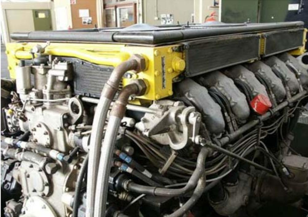
AVSI-1790-6A 型 12 缸风冷喷射式汽油机 [资料图片]
