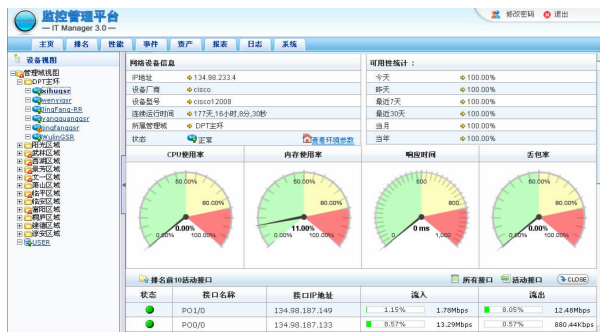
图6 NetManager性能监控
