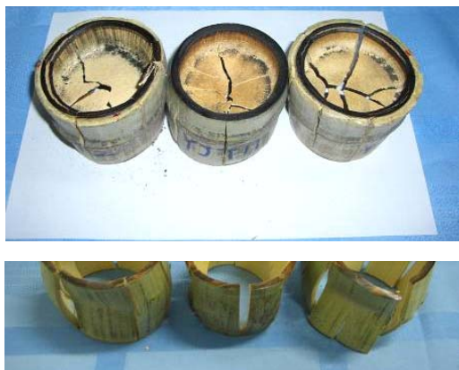
图 8 径高比 1:1 竹筒压缩破坏特征
