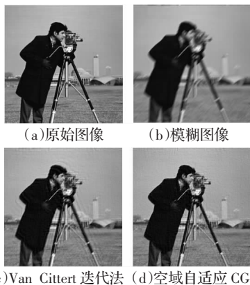
图3 在运动模糊算子大小 9x9 加性高斯噪声 \sigma=0.01 情况下两种方法去模糊效果对比
