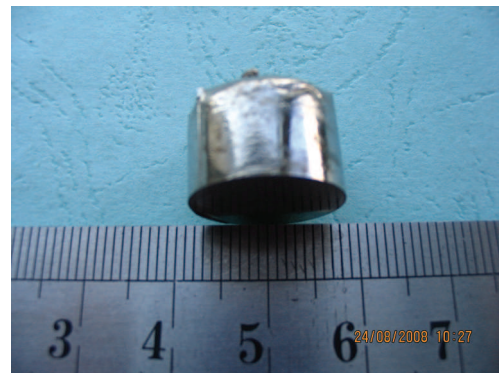
图 2 直径为 16 mm 的 (\text{Zr}_{50.7}\text{Cu}_{28}\text{Ni}_9\text{Al}_{12.3})_{99}\text{Gd}_1 非晶合金样品的外观图
