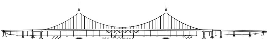
5. 张拉吊索，同时拆除支架、贝雷梁，临时支墩，浇筑索鞍以上桥塔混凝土，完成桥塔施工，安装预制槽形板和悬挑横梁。
