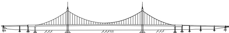
6. 进行桥面铺装，安装栏杆、路灯等设施，完成桥塔索鞍以上部分及装饰工作，最后再重新调吊索力，主缆缠丝，做主缆防护。
