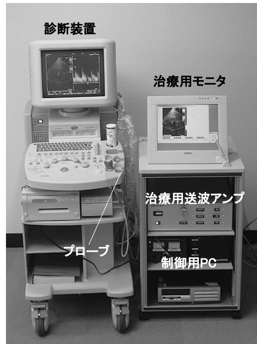
図4 「経頭蓋超音波脳血栓溶解装置」の基本構想
