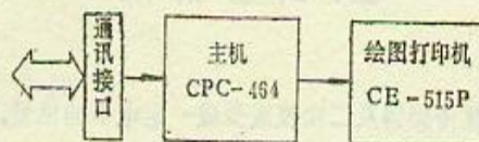
图3 现场岩体剪切试验数据采集处理设备处理机框图
