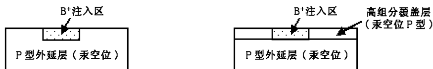
(1) 同质结 N-on-P 结构，外延材料主要使用 LPE 和 MBE
