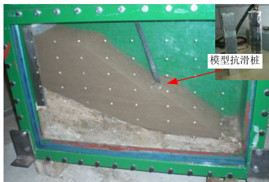
图 2 库区边坡抗滑桩加固离心模型图
